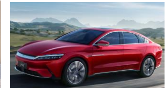
BYD Han EV Type: Pure EV Max power : 363 kW Max Battery : 77 kWh
