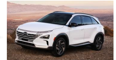
Hyundai NEXO Type : Fuel Cell EV Max range: 664 km Max Battery : 1.56 kWh
