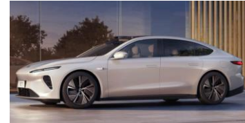
NIO eT7 Type: Pure EV Max power : 480 kW Max Battery : 100 kWh
