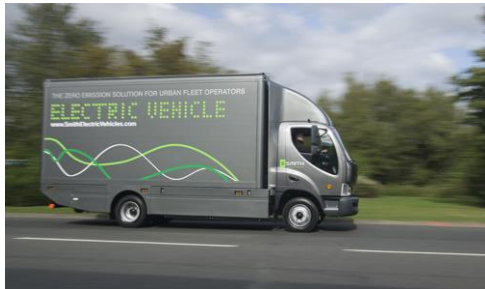
Smith EV (Avia) Type: Pure EV Max range : 241 km Max Battery : 120 kWh
