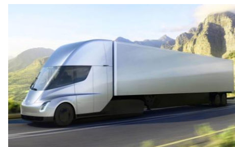
Tesla Semi Type: Pure EV Max range : 804 km Max Battery : 500 kWh
