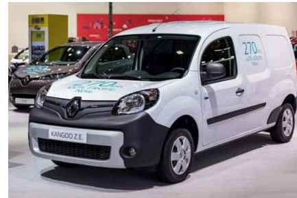
Renault Kangoo ZE Type: Pure EV Max range : 200 km Max Battery : 33 kWh
